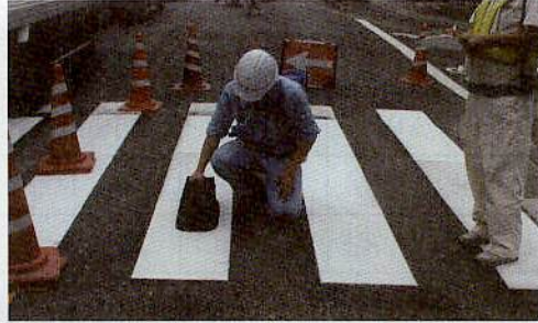
反射輝度測定状況
